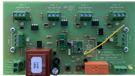
Récepteur Mono-Zone Radio fréquence 868 MHz
