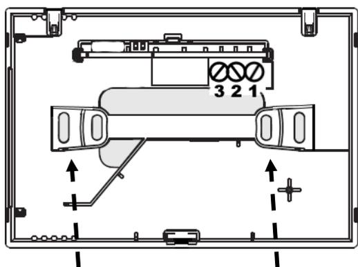
Trous pour vis de fixation au mur.
